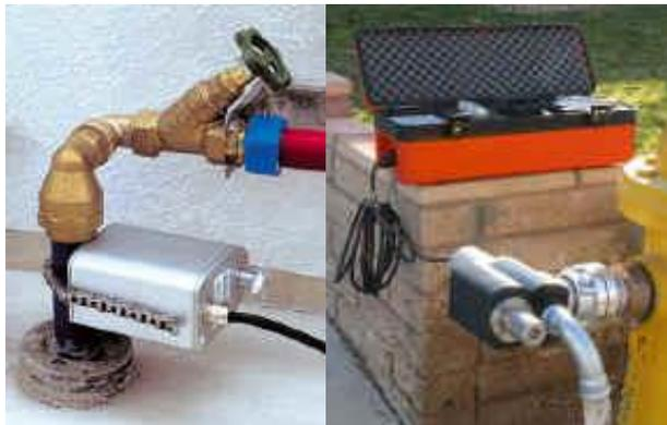
Figura: Localizador de tubos acústicos. Knocker a la izquierda. Pulsador de presión a la derecha. (Fuente: RJM Equipment Sales, Inc.)
