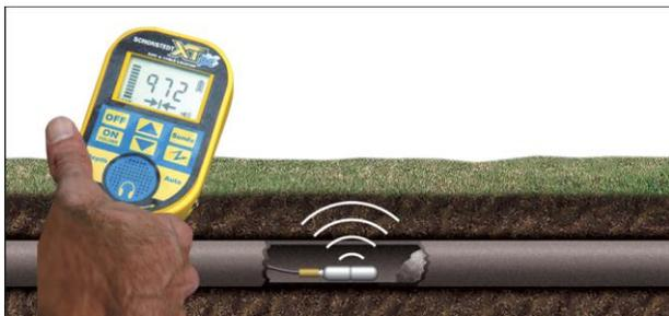
Figura: Localizador de Sonda (Schonstedt XT) (Fuente: MegaDepot)
