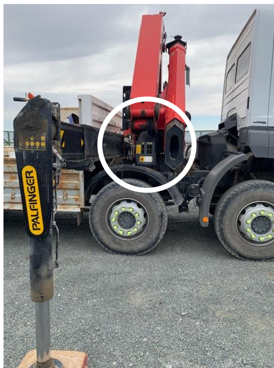
No Aceptable – Panel de Control en la LoF del Operador
