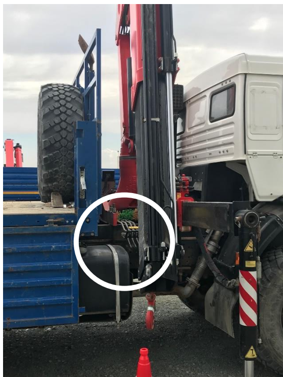
No Aceptable – Panel de Control en la LoF del Operador
