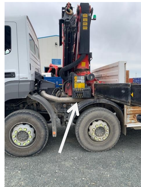
Aceptable – Panel de Control fuera de la LoF
