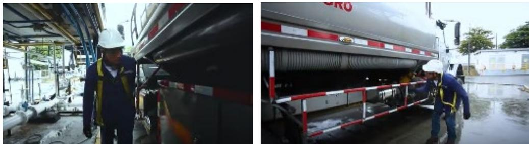
3. Coloque los frenos de estacionamiento y del remolque, apague el motor y mantenga puertas y ventanas cerradas.
