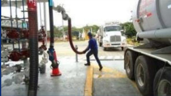
12. Desconecte la manguera de recuperación de vapores y ubíquela en su soporte.
